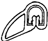
365035, Gasket Access doorjamb
