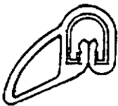
365035, Gasket Access doorjamb
