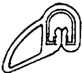
365035, Gasket Access doorjamb
